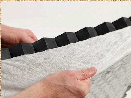
**+** Géotextile fixé thermiquement et extrêmement résistant
